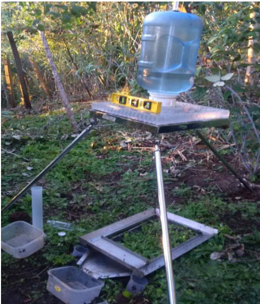
Figura 2. Simulador tipo CIAT utilizado para la evaluación de pérdida de suelo en campo
